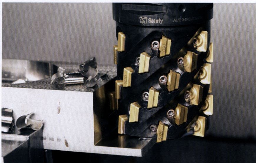
Bild 1: Das innovative SideLokTM-Klemmsystem ermöglicht die Aufnahme bis zu doppelt so vielen Wendeschneidplatten am Werkzeug, ergo können mehr Schneiden gleichzeitig in das Werkstück eingreifen. Der Tischvorschub lässt sich prozesssicher um bis zu 50 % erhöhen, so dass die Zerspanrate enorm ansteigt
